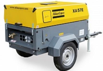
Что первое бросается в глаза – это компактные размеры компрессора, он на 30% меньше существующих аналогов и весит также на 30% меньше. Компрессор доступен в комплектации на шасси с выдачей ПТС или ПСМ для буксирования за транспортным средством или без шасси для стационарного применения.
