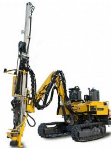
Схожие по габаритам установки AirRoc проигрывают T30 r в мобильности из-за необходимости использовать внешний компрессор, а пневматический перфоратор уступает по производительности гидравлическим перфораторам серии COP.
