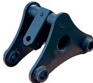
Двухпальцевый адаптер - самый распространенный тип соединения между рукоятью экскаватора и гидровращателем, крепление осуществляется на два ковшевых пальца. При двухпальцевом креплении гидробура у него не отнимаются степени свободы, гидровращатель меньше «болтается» при бурении и передвижении самой техники с места на место.
